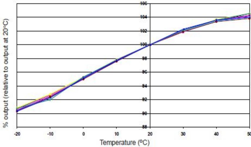
图2显示了由温度变化引起的传感器灵敏度变化。
