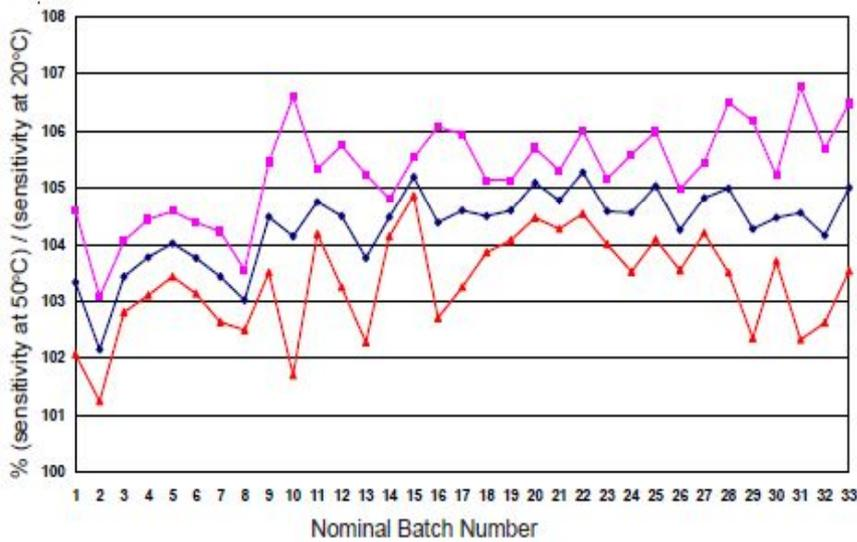
图3所示为34个批次传感器的灵敏度平均值和±95%置信区间，它显示了各批次传感器灵敏度特性的优越可重复性，这使用户能安心地在气体检测仪中设置温度补偿。
