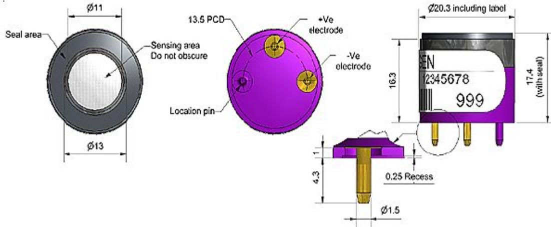
All dimensions in millimetres ( $\pm 0.15\text{mm}$ )
